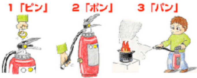
1 レバーの下側だけを片手で持つ 2 安全栓を抜く 3 ノズルを火元に向ける 4 レバーを握って、消火剤を放射
