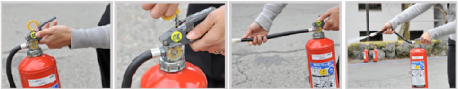
1 レバーの下側だけを片手で持つ 2 安全栓を抜く 3 ノズルを火元に向ける 4 レバーを握って、消火剤を放射
