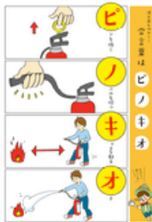
1 レバーの下側だけを片手で持つ 2 安全栓を抜く 3 ノズルを火元に向ける 4 レバーを握って、消火剤を放射
